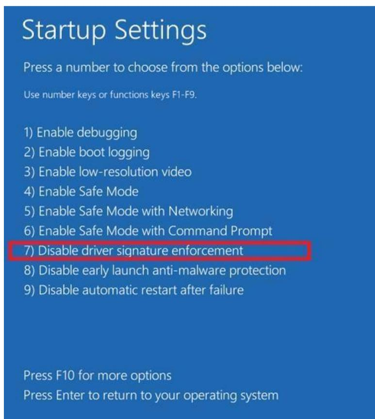
В результате Windows 8 загрузится в режиме, в котором возможна установка подписанных драйверов. Теперь при установке такого драйвера в Windows 8 появится окно с предупреждением системы безопасности Windows. После того, как вы установите драйвер и перезагрузите компьютер, проверка подписывания драйверов снова будет включена автоматически.
