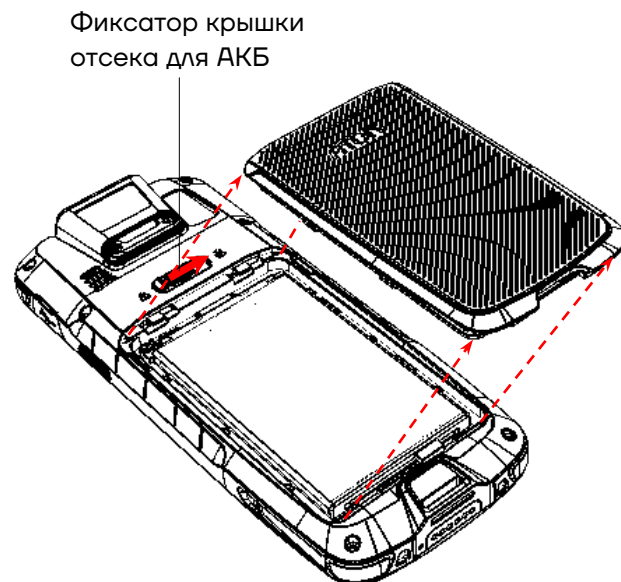
Рисунок 5. Отделение крышки отсека для АКБ от корпуса
