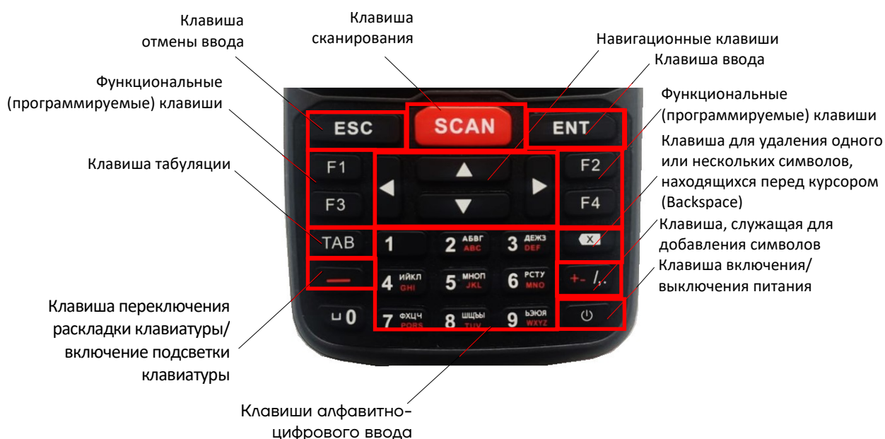
Рисунок 14. Клавиатура устройства (основные клавиши)
