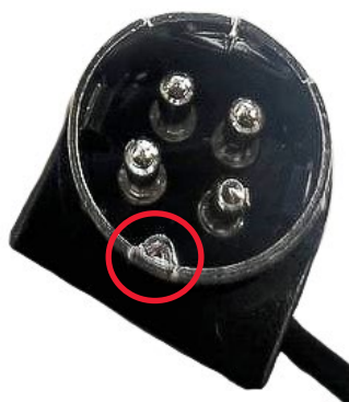
Рисунок 20. Ключ, защищающий от неправильного подключения
